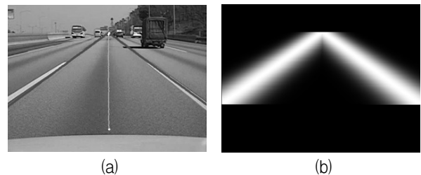
그림 6. 차선 검출을 위한 가중치 계산의 예 : (a) 차선 검출 영상 (b) 가중치 계산 결과 Fig. 6. Example of weight computation for lane detection : (a) lane detection image (b) weight image.
