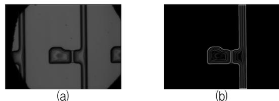
그림 8. Canny enhancer 결과 (a) Gaussian filter 결과, (b) Canny enhancer 결과
