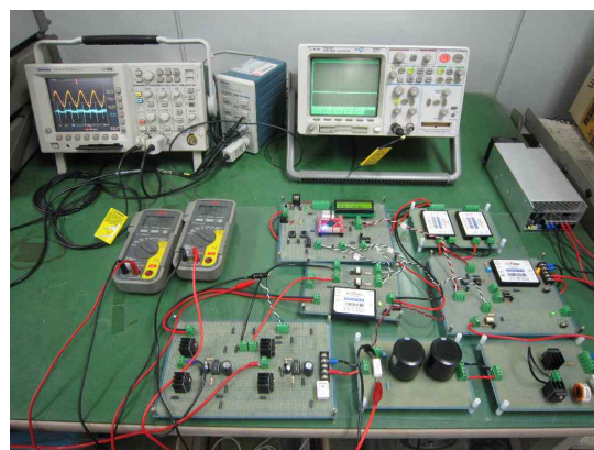
그림 12. PVDF film Actuator 구동용 파워 드라이버 실험 Fig. 12. Power driver for PVDF film Actuator experiment.
