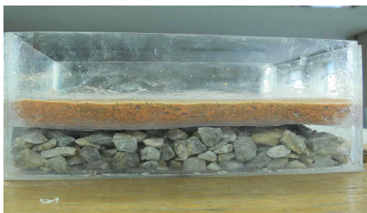
그림 17. 준설토 탈수 실험을 위한 모형지반 Fig. 17. Geotechnical models for dredged sediment dehydration experiment.
