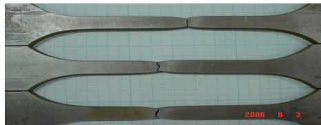
Fig 3-2 피가공재( SNCM220)의 인장 시험편
