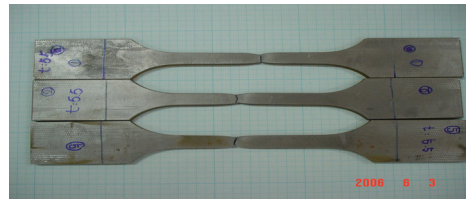
소재 : SNCM220 인장시험 결과 Fig 3-1 True Stress-Strain Curve
