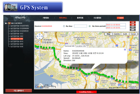
그림 12. GPS 이용 차량 추적 시스템 Fig. 12. Vehicle tracking system using GPS
