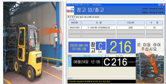
그림 6. 출하장에 진입되는 제품정보의 태그를 이용한 전송 Fig. 6. Using tag, information transmission of products into the warehouse
