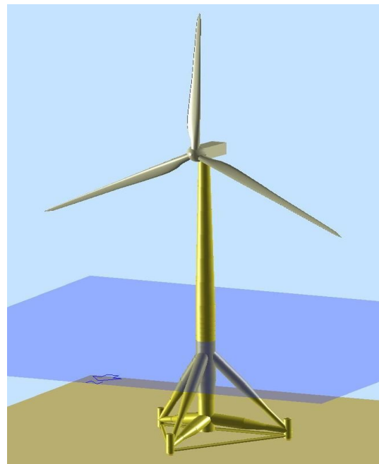
그림 1. 5MW tripod 해상용 풍력터빈의 형상
