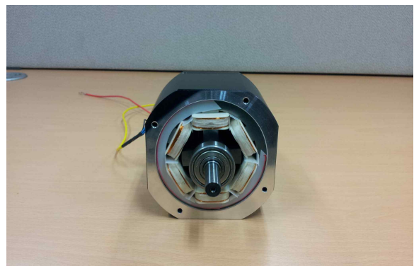
그림 6. 제작된 6대4구조 스위치드 릴럭턴스 전동기 Fig. 6. Manufactured SRM( 6/4 pole)
