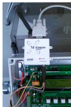
그림 10. CDMA 무선통신 모듈 Fig. 10. CDMA Wireless Communication Module
