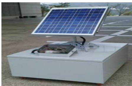
그림 8. 이동식 보조관측망 계측기 외형 Fig. 8. Appearance of Traveling Sub-Observation Measuring Instrument
