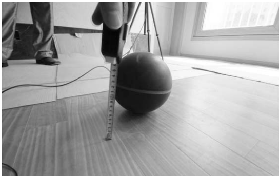
그림 7 물리적 보행감 측정에 사용된 임팩트볼
