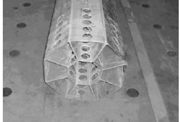
그림 2. GFRP를 적용한 풍력타워 단면
