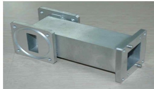
그림 5. 제작된 셉텀 편파기 Fig. 5. Manufactured Septum Polarizer
