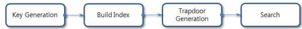
그림 4. 검색 가능 암호 시스템의 기본 구성 Fig. Basic structure of searchable encryption system
