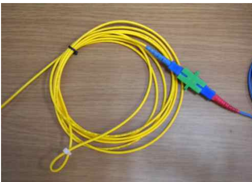
그림 4. 매크로 밴딩 이벤트를 위한 광 케이블 Fig. 4. Optical cable for macrobanding event
