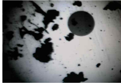
그림 5. 이물질이 부착된 광 커넥터 내부 Fig. 5. Inner part of optical connector with foreign substance such as dust
