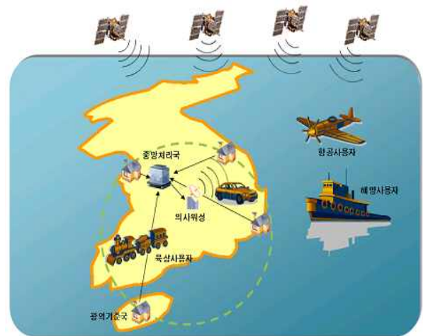
그림 1. 의사위성기반 광역보정시스템 개념도 Fig. 1. Pseudolite-based WADGNSS
