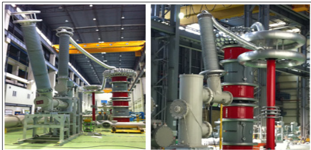
그림 4 아크접촉자 거리에 따른 내전압 시험 Fig. 4 Withstand voltage test at different distance between arc contacts
