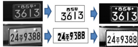
그림 8. 번호판 영상에서 문자 배치 정보를 바탕으로 기하학적 왜곡 보정 및 크기 정규화를 수행한 예
