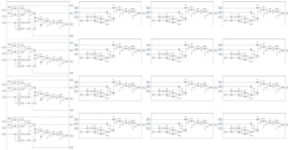
그림 7. 4×4의 연산 셀 배열 예 Fig. 7 An example of 4×4 calculation cells array
