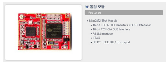
그림 5. Binary-CDMA RF 통합 모듈 Fig. 5 Binary-CDMA RF Integration Module
