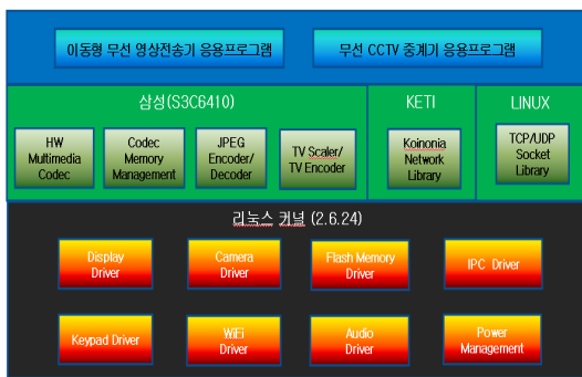
그림 6. 무선 CCTV 시스템 소프트웨어 아키텍처 Fig. 6 Software Architecture of Wireless CCTV System
