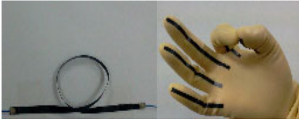
그림 1. MWCNT/ 폴리우레탄 인공신경. Fig. 1. MWCNT/ polyurethane composite artificial neuron.
