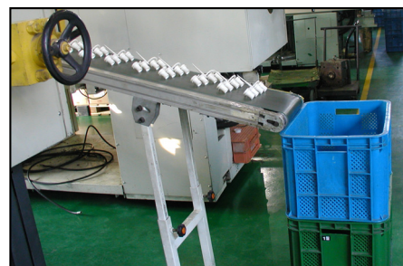
[Fig. 15] Install a conveyor.
