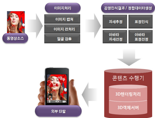
[그림 9] 실시간 정합과정 시스템 순서도
