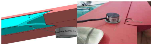
Fig. 7. 조종면 작동각 측정 센서 장착 형상
