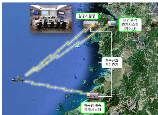
그림 1. 항공시험장 계측시스템 구성
