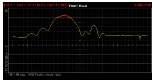
그림 16. 중계포트 위상제어 시험 결과 (빔각 -20°, 빔폭 22.4°)
