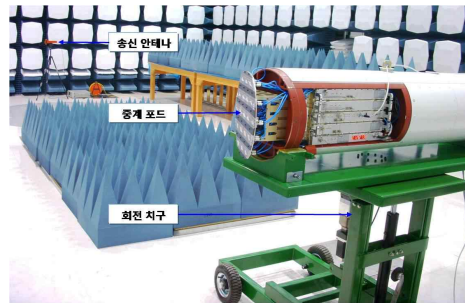
그림 15. 중계포트 위상제어 시험 사진
