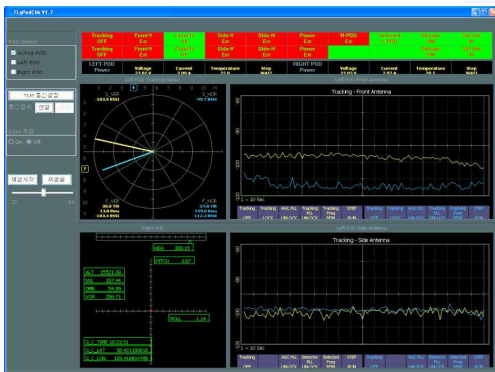
그림 22. 중계시스템 모니터링을 위한 중계포드 상태시현 프로그램
