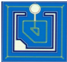
[그림 5] 칩의 구조 [Fig. 5] Structure of fabricated chip
