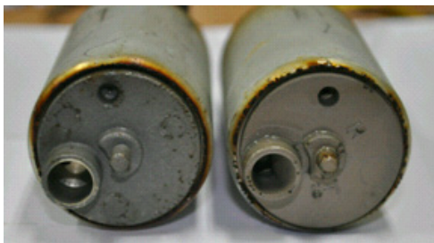
[그림 12] 250시간 부식 실험 후 연료 펌프 (좌 : 단조, 우 : 다이캐스팅) [Fig. 12] Fuel pump after 250 hrs corrosion test (left : Cold forging, right : die casting)
