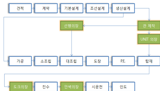
[그림 2] 선박 건조 과정 중에 의장품 탑재시점들 [Fig. 2] Erection time of outfitting equipment during the hull construction
