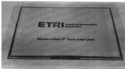
그림 9. 15인치급 윈도우 일체형 TSP (한국전자통신연구원 개발).
