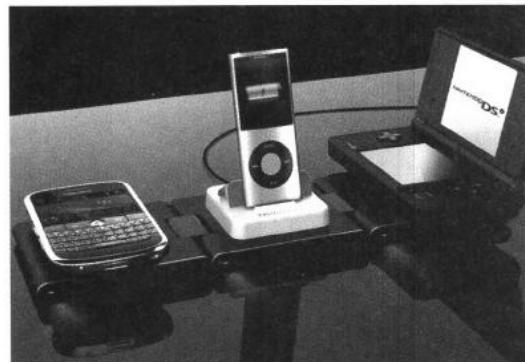
[그림 2] Duracell Powermat 社의 무선 충전 시스템(Powermat)
