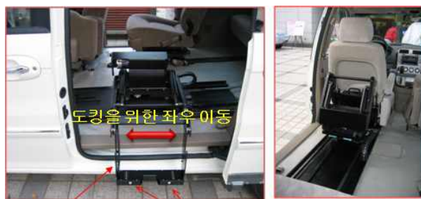
리프트 초음파센서 리프트와 휠체어의 도킹 후 모습
