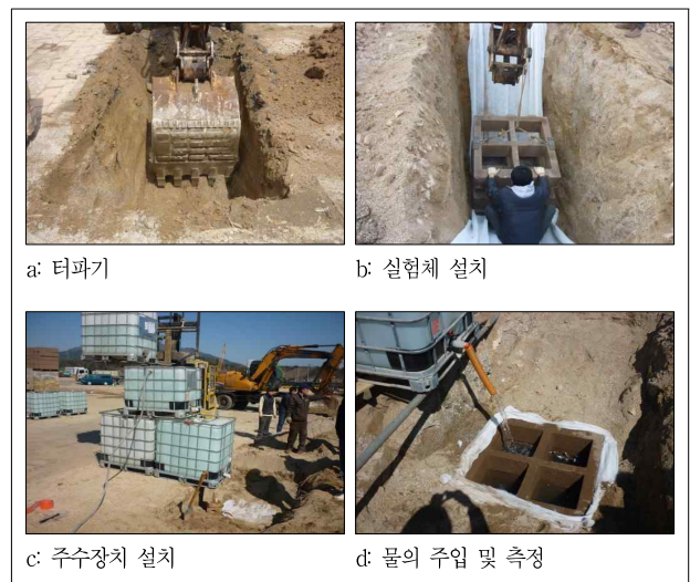
그림 3. 실험체의 현장설치 및 정수위시험 현황
