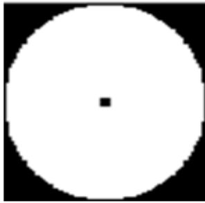
그림 11. 공간주파수 영역에서 제안된 Bandpass filter의 특성
