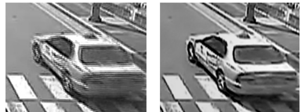
(a) 비월주사 방식 CCTV 원본 영상 (b) 라인 더블링 방식으로 순차주사화 된 결과 영상
