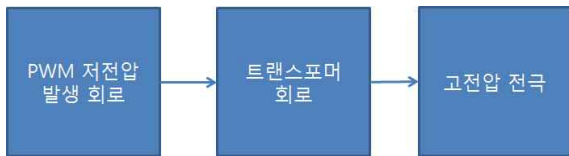
그림 1. 고전압 펄스 발생 회로 구조 Fig. 1. Circuit of High Voltage Pulse Generator
