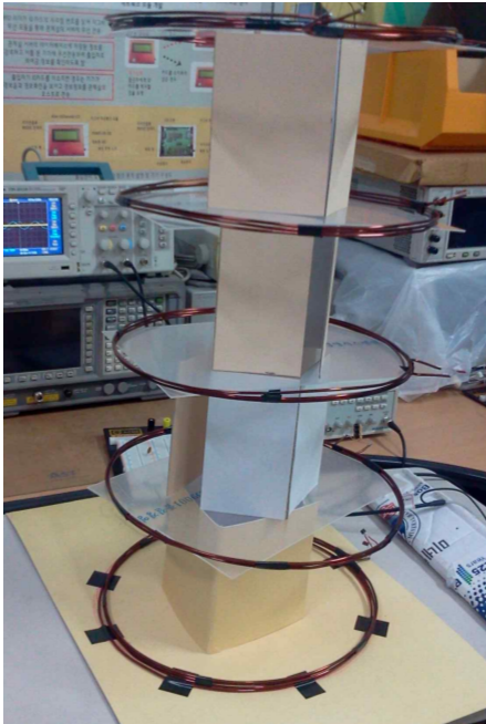
그림 7. 다수의 중계 코일이 삽입된 무선 전력 전송 장치 Fig. 7. The wireless power transfer system inserted with several intermediate coils
