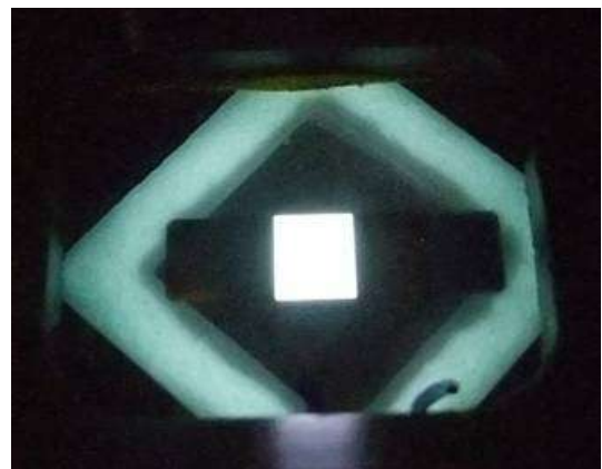
그림 6. 완성된 3개의 발광층을 갖는 3파장 WOLED Fig. 6. 3-wavelength WOLED with a 3-emissive layer
