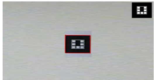
그림 8. 원본 마커와 템플릿 매치된 마커 Fig 8. Original marker and template-matched marker
