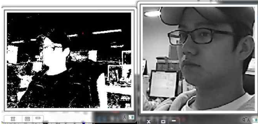
Fig 7. Face Region Detection using Skin Color 그림 7. 피부색을 이용한 얼굴 영역 검출
