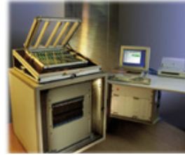
그림 1. Bed of Nail Tester와 Fixture Fig. 1 Bed of Nail Tester and Fixture
