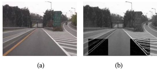
그림 7. 허프 변환을 수행한 영상 (a) 입력 영상 (b) 허프변환 적용 결과 Fig. 7 image of hough transformation (a) input image (b) results of hough transformation
