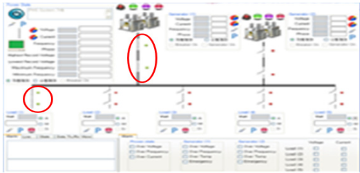
그림 9. 발전기와 부하가 한 개씩 가동 중일 때 Fig. 9 In case of a generator and a load operate
