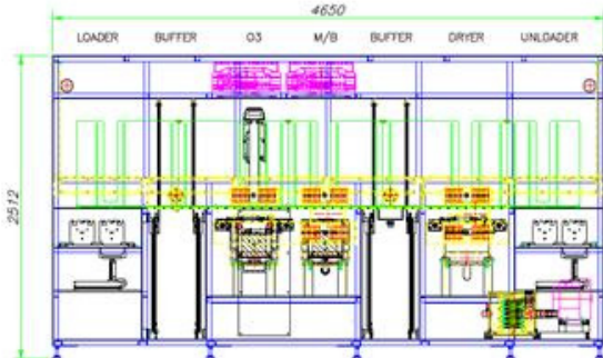
그림 2 오존마이크로 버블 시스템 설계도 Fig. 2 System diagram for ozone micro bubble
