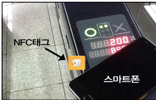
(그림 3) 지하철 개찰구에 붙여진 NFC 태그를 인식하는 스마트폰
