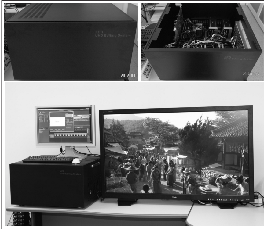
〈그림 8〉 구현된 UHD 콘텐츠 획득/저장/편집 시스템 및 시연 모습
