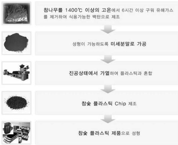
그림 2. 숯 플라스틱 칩 및 제품 제조 공정. 참나무를 1400°C 이상의 온도에서 가열하여 백탄을 얻는다. 볼밀 공정을 통해 참숯을 직경 마이크로미터 사이즈의 미세분말로 가공한다. 이러한 미세분말과 플라스틱 원료를 혼합하여 밀리미터 크기의 칩 상태로 제조한다. 이 칩을 재료로 하여 여러 성상의 포장용기 제품으로 성형을 한다.
