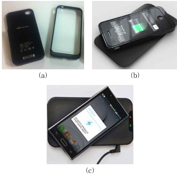
그림 4. (a) LS전선의 아이폰4용 커버 (b) LS전선의 아이폰4용 무선충전솔루션 (c) LG전자의 옵티머스2 LTE, WPC 충전 기능 내장 [19, 20]
