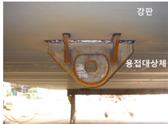
그림 1. 자동 로봇 용접 대상체 Fig. 1. Autonomous robotic welding parts.
