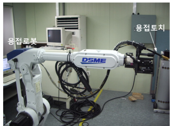
그림 2. 용접 토치가 부착된 자동 용접 로봇 Fig. 2. Autonomous welding robot with a welding torch.
