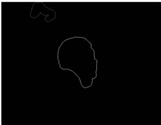
그림 5. 경계선 추적 및 최대 경계선 길이 물체 검출
