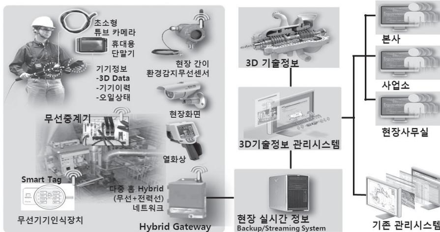
그림 4 화력발전 플랜트 상태기반 정비지원 정보화시스템 기반 구축 개요도 (한국기계연구원)
