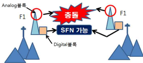
그림 10. Analog + Digital Hybrid방법에서 SFN 구성이 어려운 이유 Fig. 10. The reason why SFN is difficult in the Analog + Digital Hybrid method
