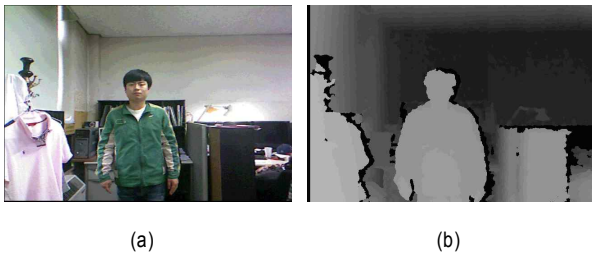
그림 2. kinect RGB+depth 영상의 예: (a) RGB 영상, (b) 깊이 영상 Fig. 2. RGB + depth images by kinect: (a) RGB Image, (b) depth image
