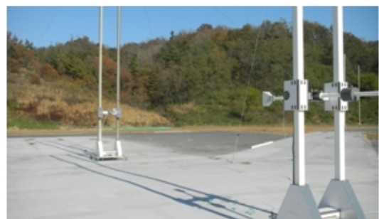
그림 4. 안테나 교정 야외시험장 Fig. 4. OATS for antenna calibration.
